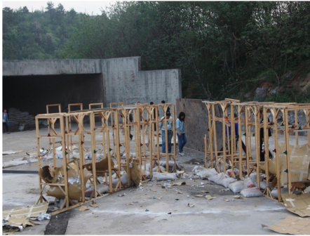
图 8 爆轰作用后实验现场纸靶照片
