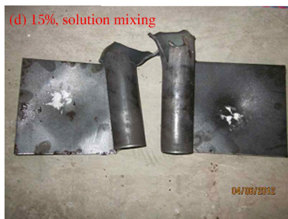
图 3 添加 KCl 的硝酸铵联合国隔板实验实物结果图
