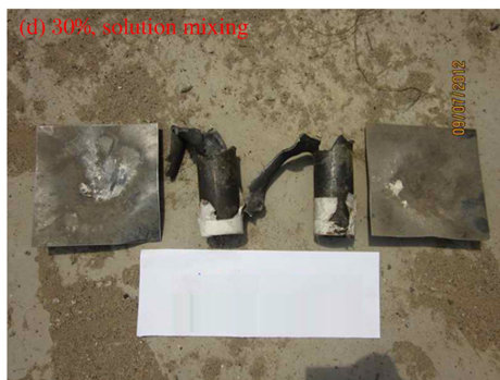
图 5 添加 \text{NH}_4\text{H}_2\text{PO}_4 的硝酸铵联合国隔板实验实物结果图
