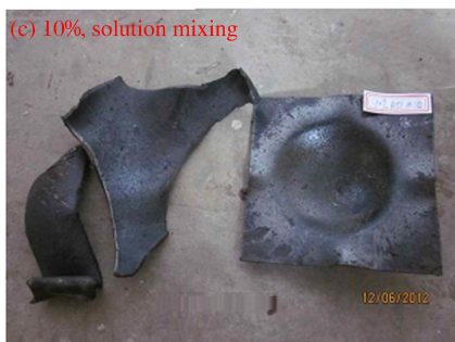
图 3 添加 KCl 的硝酸铵联合国隔板实验实物结果图
