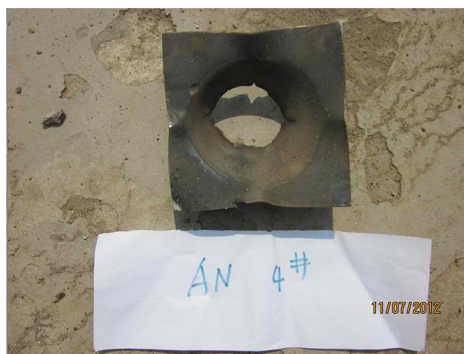
图 2 纯硝酸铵的联合国隔板实验实物结果图
