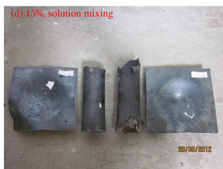
图 4 添加 NaCl 的硝酸铵联合国隔板实验实物结果图
