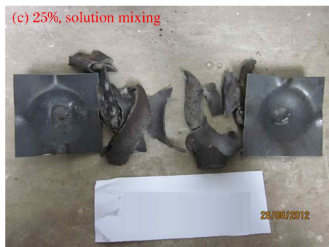
图 5 添加 \text{NH}_4\text{H}_2\text{PO}_4 的硝酸铵联合国隔板实验实物结果图
