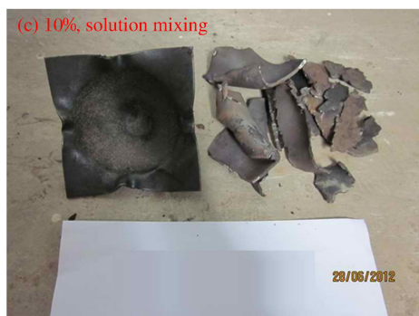
图 4 添加 NaCl 的硝酸铵联合国隔板实验实物结果图
