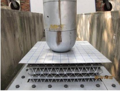
图 12 模型整体破坏情况图
