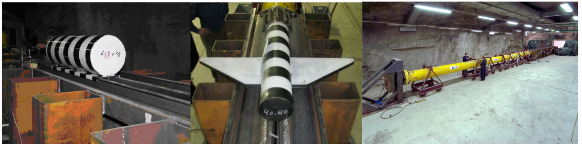
图 2 装有液体的弹体撞击试验装置
