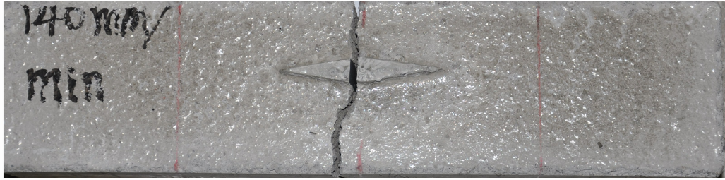
图8 快速加载试件破坏形态图
