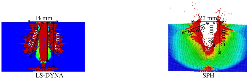
图10 不同方法模拟得到的裂纹长度及分布情况
