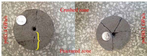
图 4 岩样 I 冲击破坏实物图
