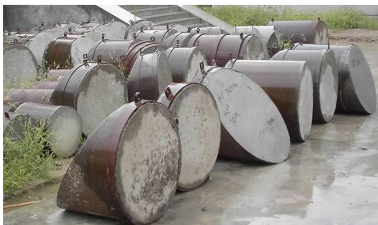
图4 实验用钢筋混凝土靶
