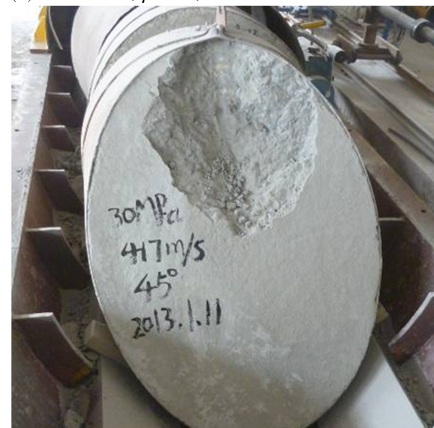
(d) v=417 m/s, \beta=45^\circ , ricochet
