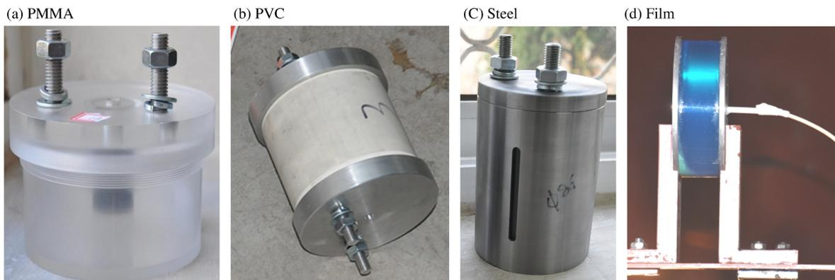
图 2 不同壳体材料的爆炸分散装置
