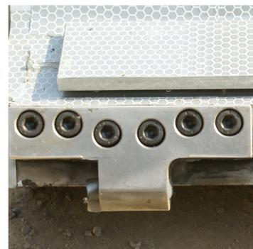
图 2 损坏铰链结构
