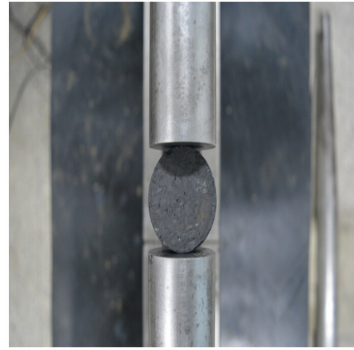
图 2 动态劈裂实验试件安装方式
