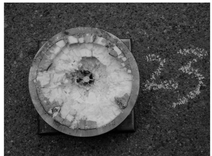
图 4 典型长杆弹侵彻后的 AD95 陶瓷靶(1 054 m/s)
