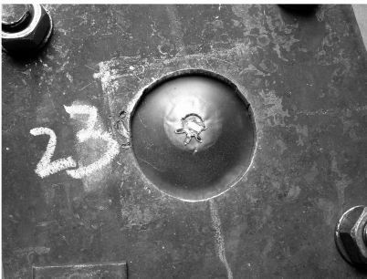
图 4 典型长杆弹侵彻后的 AD95 陶瓷靶(1 054 m/s)
