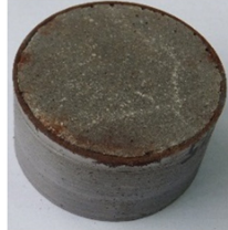
图 9 RPC-FST 破坏形态
