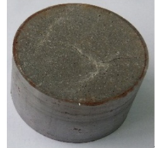
(f) 300 \text{ }^{\circ}\text{C} , \dot{\epsilon}=121 \text{ s}^{-1}
