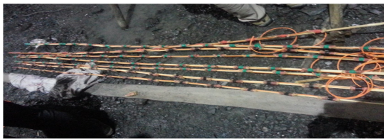
图8 试验装药结构图 Fig. 8 Charge structure
