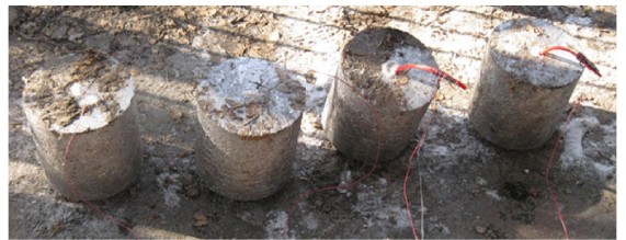
图2 炸药做功能力现场试验
