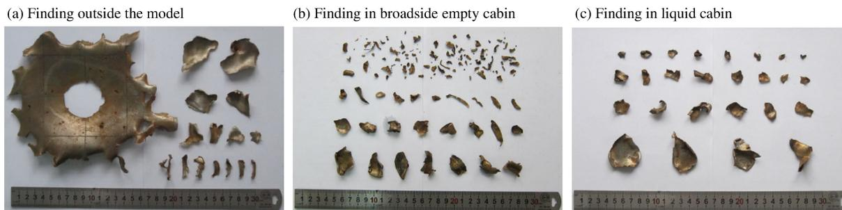
图 8 55 g 装药近水面接触爆炸下形成的破片
