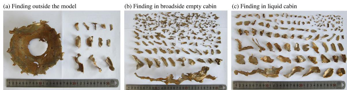
图 9 110 g 装药近水面接触爆炸下形成的破片
