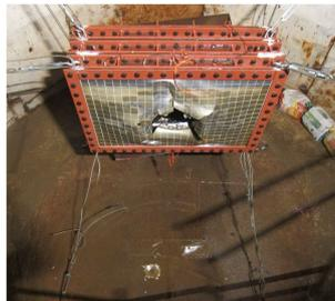
图 4 55 g 装药近水面接触爆炸下模型的破坏
