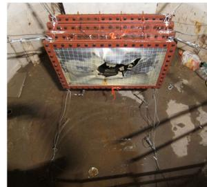
图 5 110 g 装药近水面接触爆炸下模型的破坏
