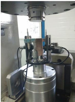
图 2 RMT-301 岩石与混凝土力学实验系统
