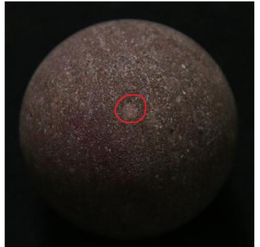
图6 砂岩球体碰撞局部接触(损伤)区域
