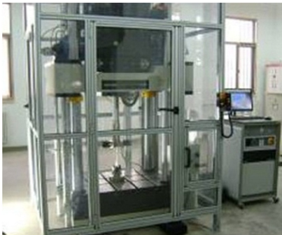
图 4 高速液压伺服试验机
