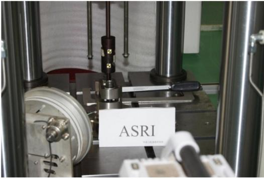
图 5 铆钉元件复合动态加载实验状态
