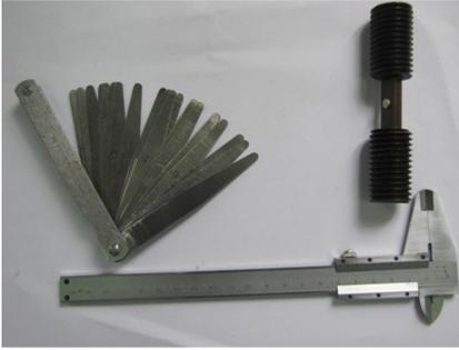
图 2 铆接工艺一致性检查工具
