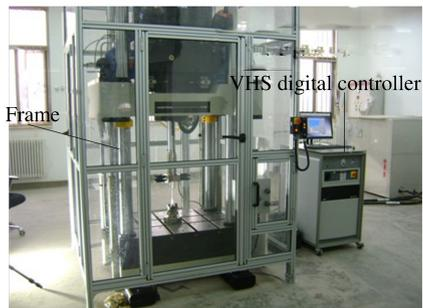
图 4 高速液压伺服材料试验机
