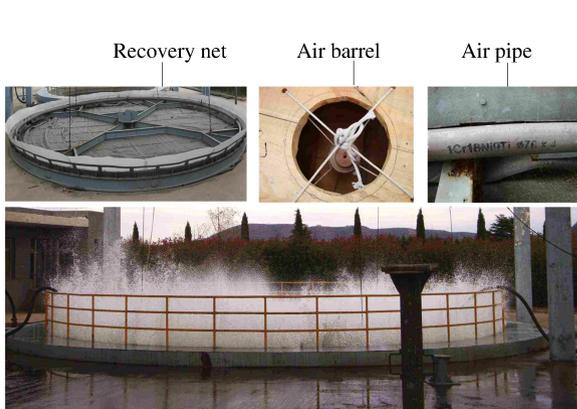
图 1 爆炸实验水池示意图
