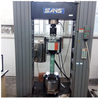
图 1 室温整体拉伸实验
