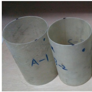
图 2 高温高压瞬态冲击试样
