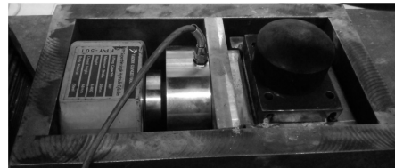
图 2 三轴试验装置实物照片
