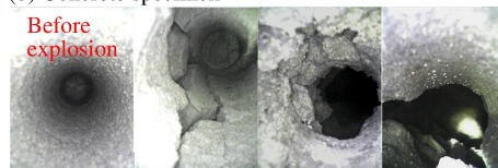
图 7 爆孔内裂隙分布
