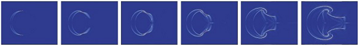
图 4 当 B=0.05\text{ T} 时激波与 R22 气柱作用过程的涡量分布图
