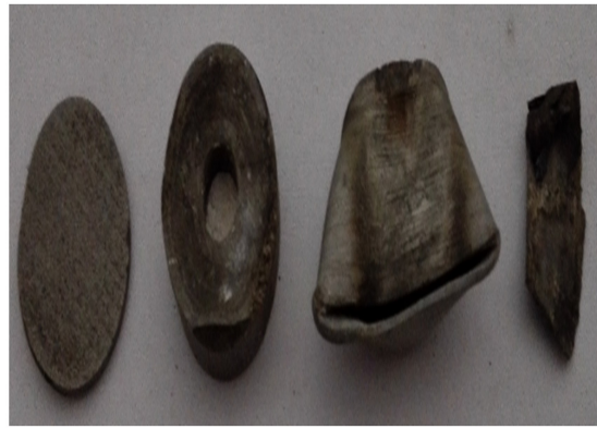
图 7 距离 8 mm 时传爆管殉爆效果 Fig. 7 Blasting effect of booster pipe at 8 mm
