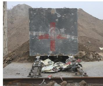
图 7 试验后靶体和飞机模型的形貌
