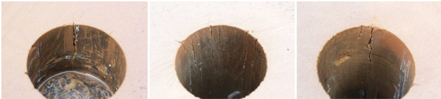
图 9 岩样 5 裂缝图片
