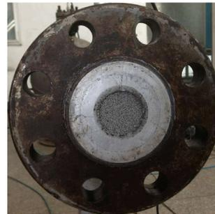
图 2 多孔材料固定方式
