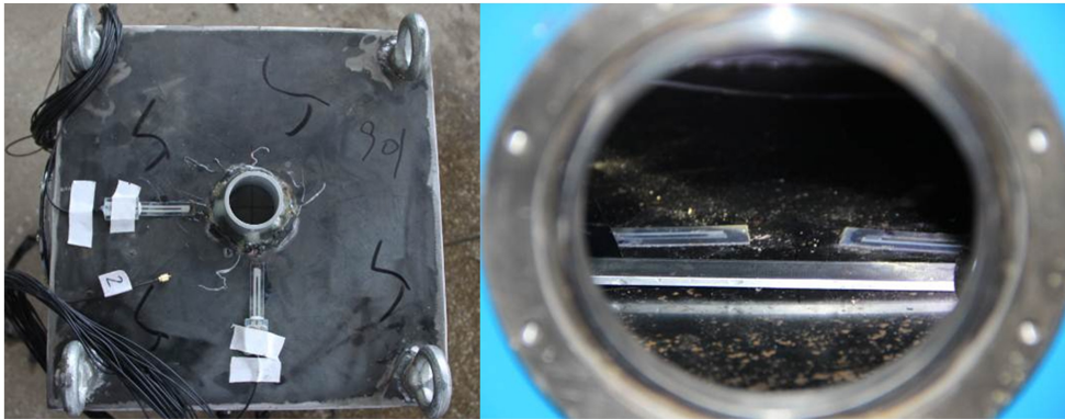
图 11 PVDF 传感器布置图 Fig. 11 Layout of PVDF sensors
