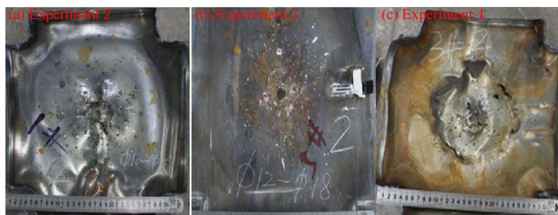
图 8 空舱后板的破坏模式
