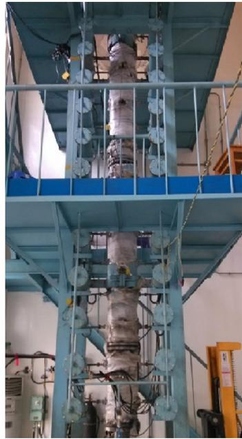
图 2 立式爆轰管结构图及实物图
