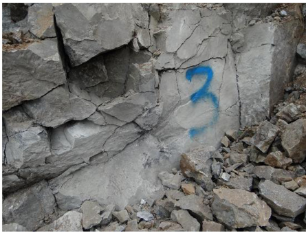
图 2 弹体冲击后岩石靶体正表面 Fig. 2 Rock target's impacted surface
