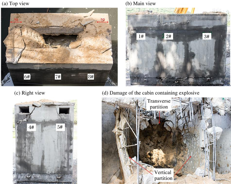
图 5 结构内部爆炸码头毁伤模式
