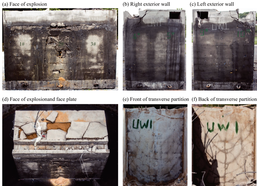
图 6 爆距 0.5 m 码头模型毁伤模式
