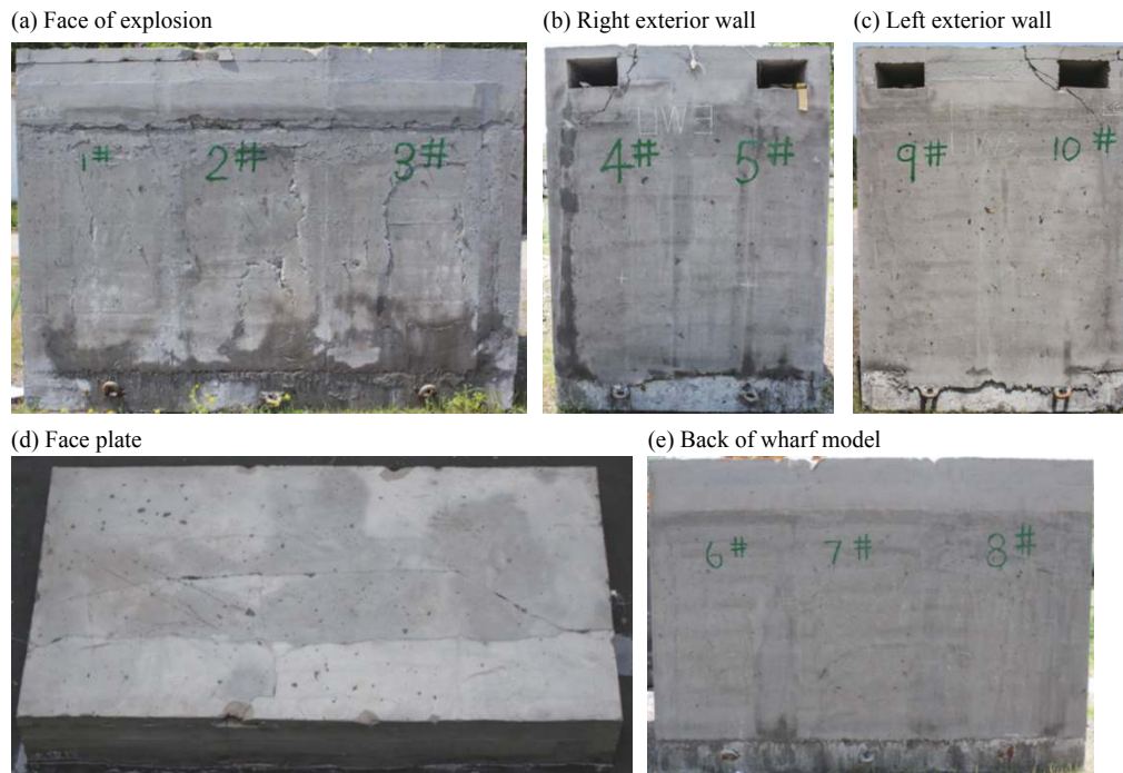
图 7 爆距 1 m 码头模型毁伤模式
