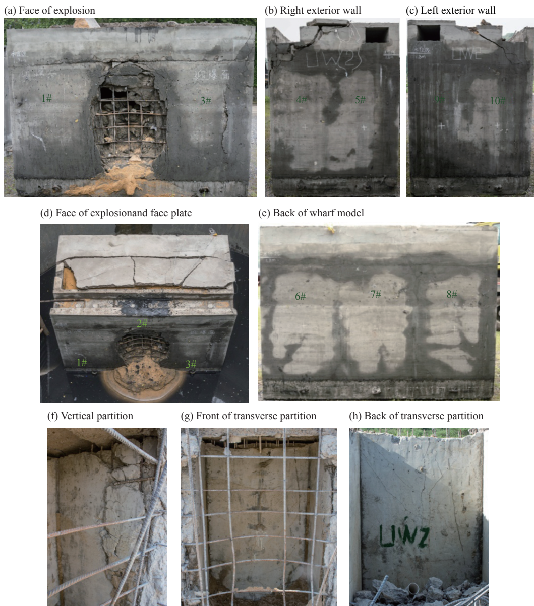
图 5 水下接触爆炸码头模型毁伤模式
