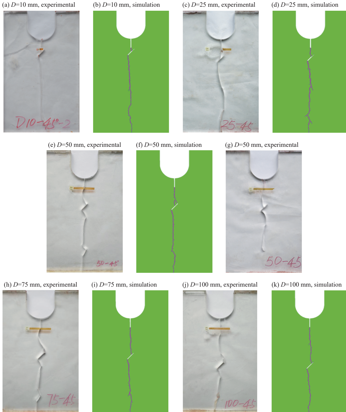
图 7 不同 D 值( D 表示竖直裂纹尖端到倾斜裂纹中心距离)裂纹扩展路径的实验和模拟对比图( \theta=45^\circ )
