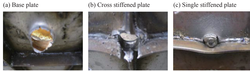
图 3 加筋板变形破坏模式 [9]
