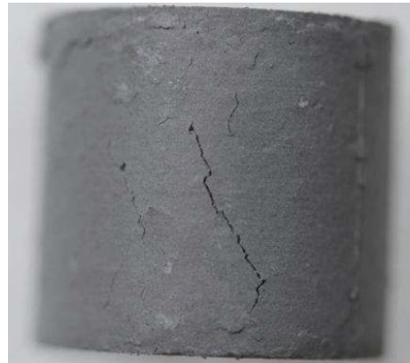
图 1 PBX-1 炸药的宏观裂纹形貌
