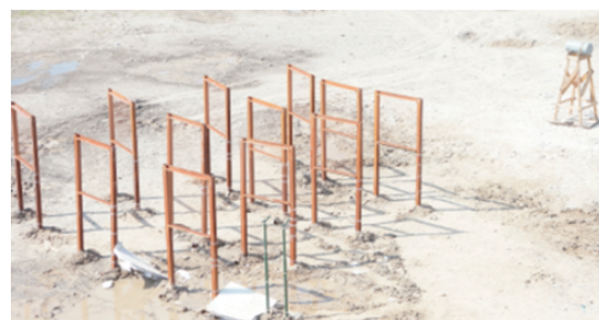
图 11 测速靶的布设
