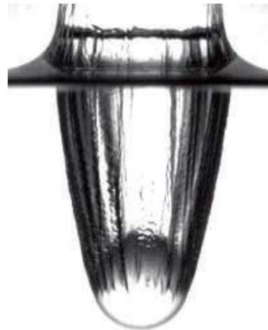
图 5 带有纳米涂层的球体入水产生的空泡<sup>[6]</sup>
