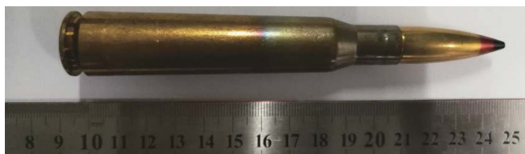
图 2 12.7 mm 口径穿甲燃烧弹
