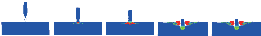
图 10 12.7 mm 穿燃弹侵彻陶瓷/铝有限厚靶损伤演化过程
