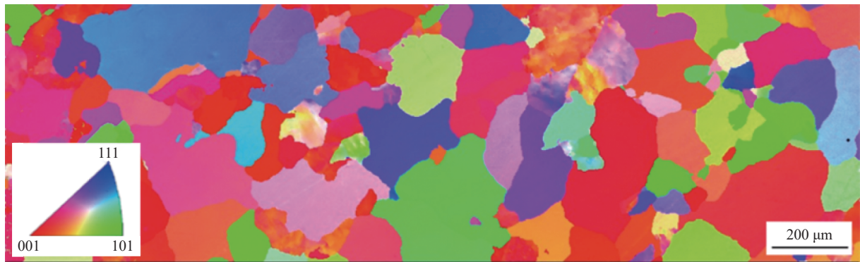
图 1 EBSD 获得的服役 30 年的 LT21 铝合金晶体取向成像图
