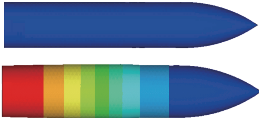
图 10 缩比弹自由状态下初始形状与第 12 阶拉伸模态振型的位移云图对比
