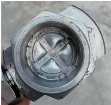
图 16 承压实验后的金属膜片 D
