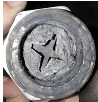
图 17 破裂实验后的金属膜片 D
