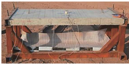
图 2 钢筋混凝土板
