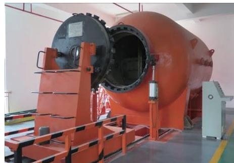
图 1 真空室爆炸模拟系统承压罐体
