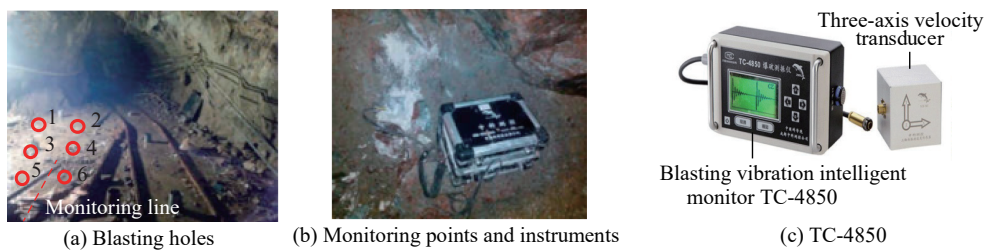
图 3 爆破试验现场及仪器布置
