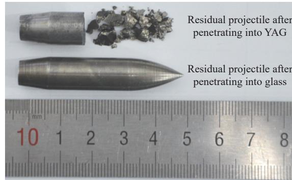
图 5 试验回收弹体
