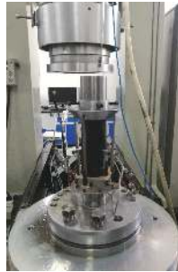
图 2 TAW-3000 型岩石试验机 Fig. 2 TAW-3000 rock testing machine
