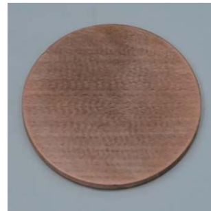
图 5 TU1 无氧铜靶片试件
