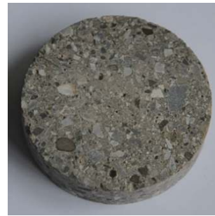
图 3 混凝土飞片试件
