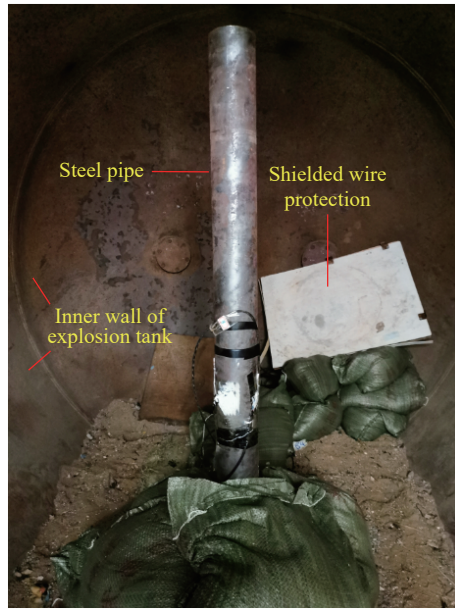
图 3 爆炸罐内钢管安放
