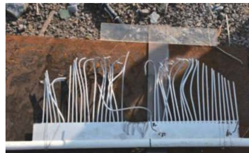
图 7 试验后应变梳 Fig. 7 Strain comb after test
