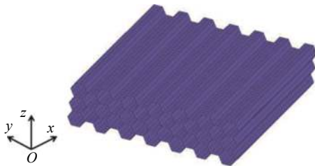
图 17 正六边形蜂窝芯层部分结构
